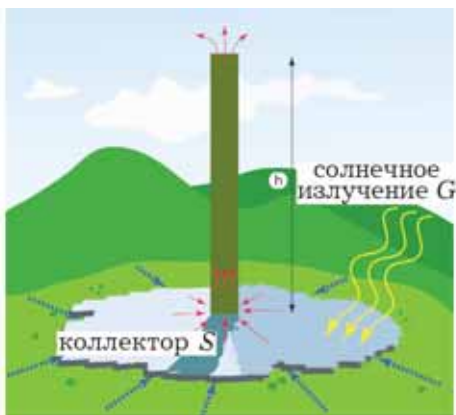
Рис. 5. Схема солнечной электростанции на основе трубы
